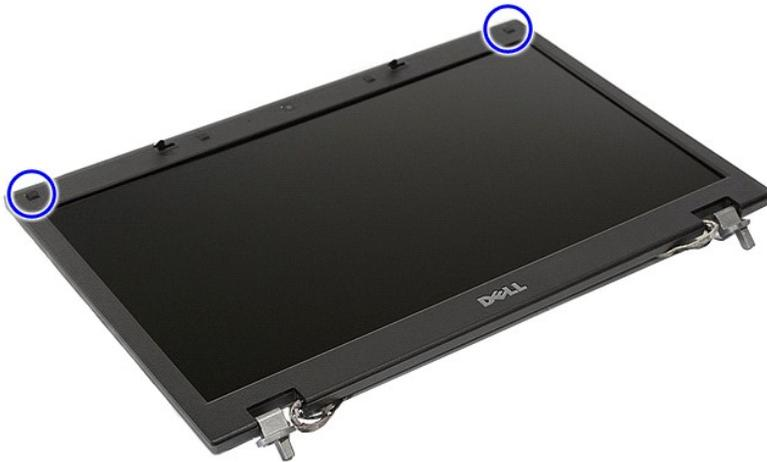
9. 取下用來將顯示幕前蓋固定至顯示器護蓋的螺絲。
