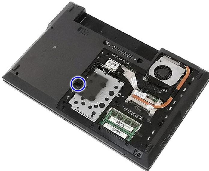
4. 將螺絲起子插入固定螺絲槽，然後小心鬆開，並將光碟機從電腦卸下。
