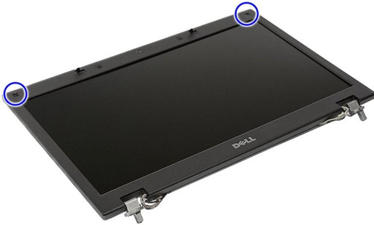
10. 以指尖從顯示幕組件的前蓋邊緣底部小心將顯示幕前蓋內緣整個撬起。
