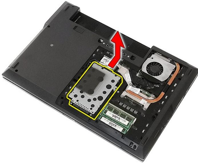
6. 卸下將硬碟機支架固定至硬碟機的螺絲。
